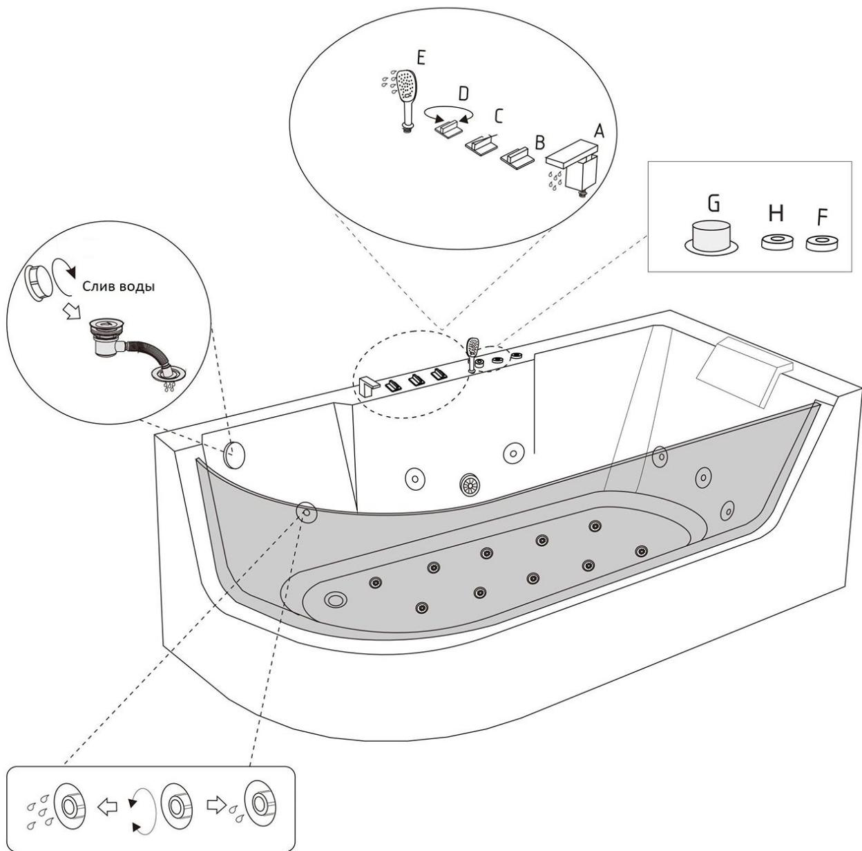
В - регулировка холодной воды
