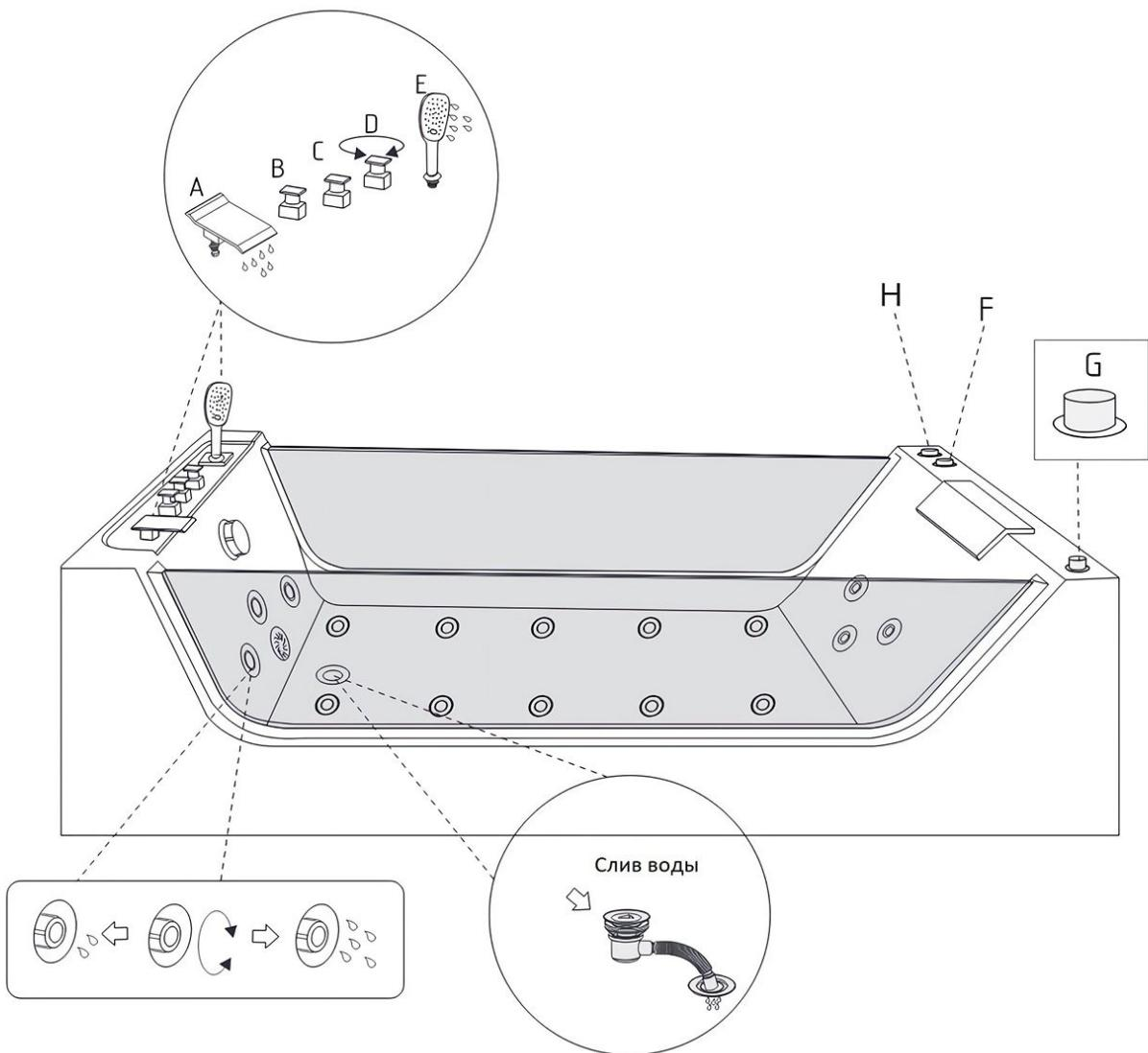
В - регулировка холодной воды
