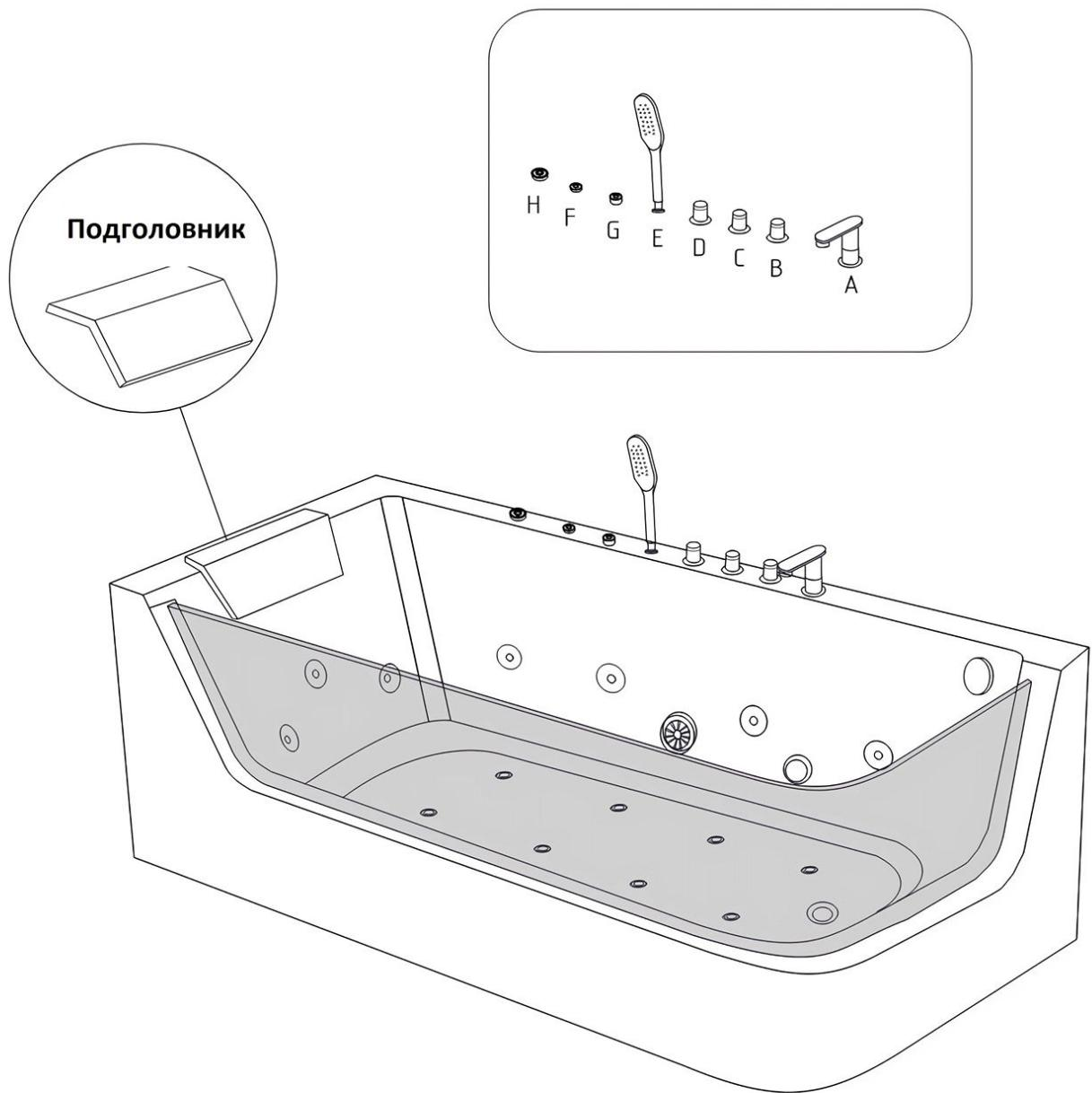
В - регулировка холодной воды
