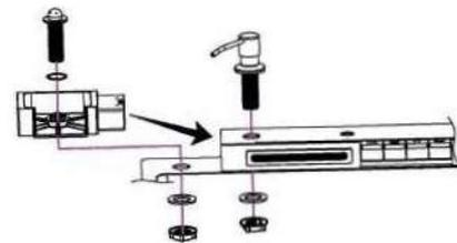
4. 1) установите излив смесителя с лейкой и зафиксируйте гайки в последовательности, показанной на рисунке.
