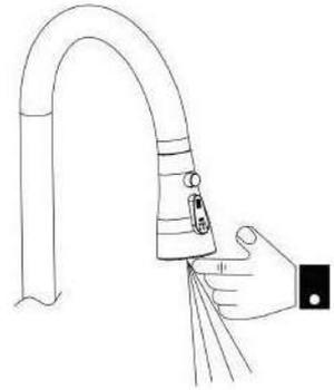
2: Выкрутите аэратор, очистите и затем установите его на место.
