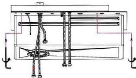
3. Вставьте ополаскиватель стаканов и дозатор моющего средства в соответствии с пазами и затяните гайки.
