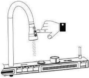
Включение потоков высокого давления.
