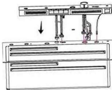
2. Закрепите панель на мойке винтами.
