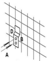
Повесить панель на крепление (монтажный кронштейн)
