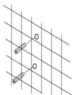
3. Закрепить винт к стене с помощью настенных кронштейнов
