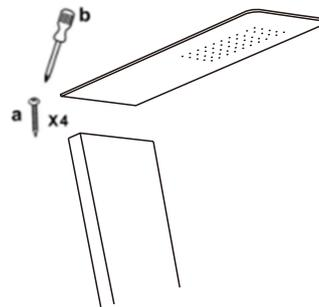
Используйте для винтов и гаек, укрепляющих верхнюю часть душевой панели
